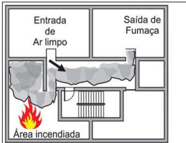
Figura 20: Extração mecânica
