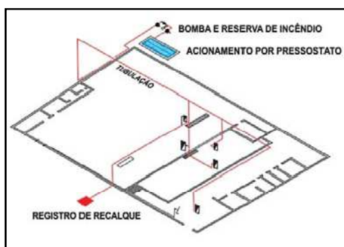
Figura 19: Perspectiva isométrica de sistema de hidrantes
