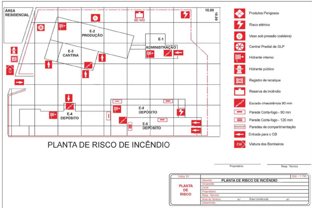
Figura 27: Planta de risco. Fonte: NT 01
