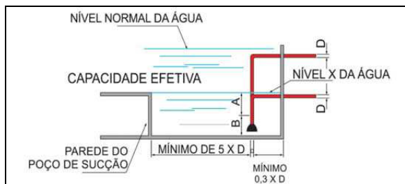
Figura B.1: Tomada superior de sucção para bomba principal
